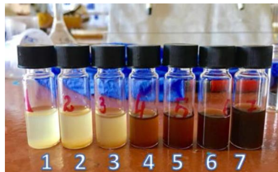
Рис. 1. Фотографія проб розчину наночастинок CdSe відібраних через 1 – 15 хв, 2 – 30 хв, 3 – 75 хв, 4 – 135 хв, 5 – 195 хв, 6 – 255 хв, 7 – 315 хв.
