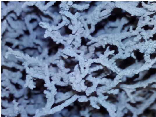
Рис. 1. Зовнішній вигляд кобальтового порошку, отриманого після автогоріння.
